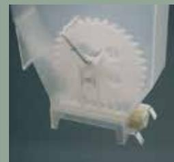
En caso de desgaste u obstrucción del husillo dosificador, es posible desmontarlo y sustituirlo en menos de dos minutos, sin que se requiera ningún tipo de conocimiento mecánico ni ninguna herramienta. Bastan las manos. En el peor de los casos, el conjunto del tanque es un elemento muy económico reemplazable por el propio usuario. Se convierten así en rutinarias labores de mantenimiento o averías que en otras máquinas resultan muy costosas.
